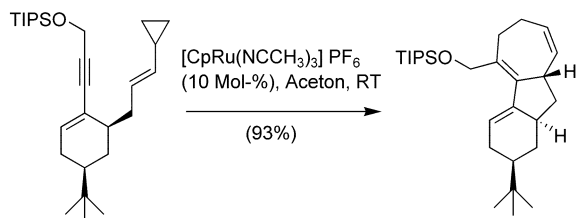
Scheme 6. Ein Beispiel für die Anwendung der Ruthenium-katalysierten [5+2]-Cycloaddition bei der stereoselektiven Synthese polycyclischer Systeme. TIPSO = Triisopropylsilyl. [22]
